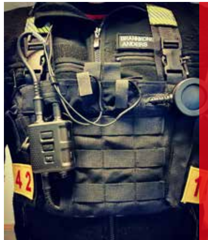
Med utvendig sambandsvest kan man styre to samband samtidig som man har et aktivt hørselvern. Sambandet styres av en styringsenhet hvor Tetra-terminal og headset er koblet til. På bildet er bare ett samband tilkoblet.
